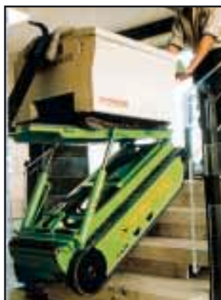
Figura 40 Trasportatore elettrico montagradi. Per spostare carichi pesanti e ingombranti quali armadi in acciaio, casse, contenitori del peso fino a 600 kg circa. Uso tipico: consegna merci, manutenzione, traslochi.
