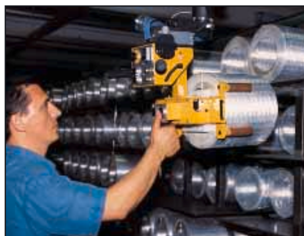
Figura 7: l'azienda ha imposto il motto «STOP – Pensa, poi solleva»: oggi lo stesso lavoro viene effettuato con un apparecchio di sollevamento («balancer» di pesi). Grazie alla meccanizzazione, il lavoro è diventato molto più sicuro, meno rischioso per la salute e la produttività è aumentata.
