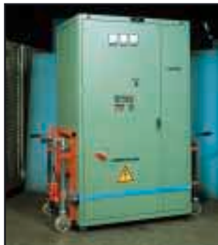
Figura 39 Accessori di trasporto. Per spostare carichi pesanti e ingombranti quali armadi in acciaio, casse, contenitori del peso fino a 1800 kg circa. Uso tipico: ricezione merci, magazzino, consegna merci, manutenzione, traslochi.
