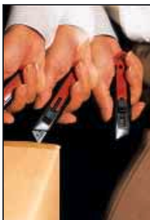
Figura 19 Coltello di sicurezza per aprire gli imballaggi, per es. nella ricezione merci. Lama atta a ritrarsi automaticamente quando perde il contatto con la superficie di taglio.
