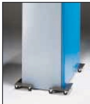
Figura 38 Rulli trasportatori. Per spostare carichi pesanti e ingombranti quali ar- madi in acciaio, casse, contenitori del peso fino a 500 kg circa. Uso tipi- co: ricezione merci, magazzino, consegna merci, manutenzione, traslochi.
